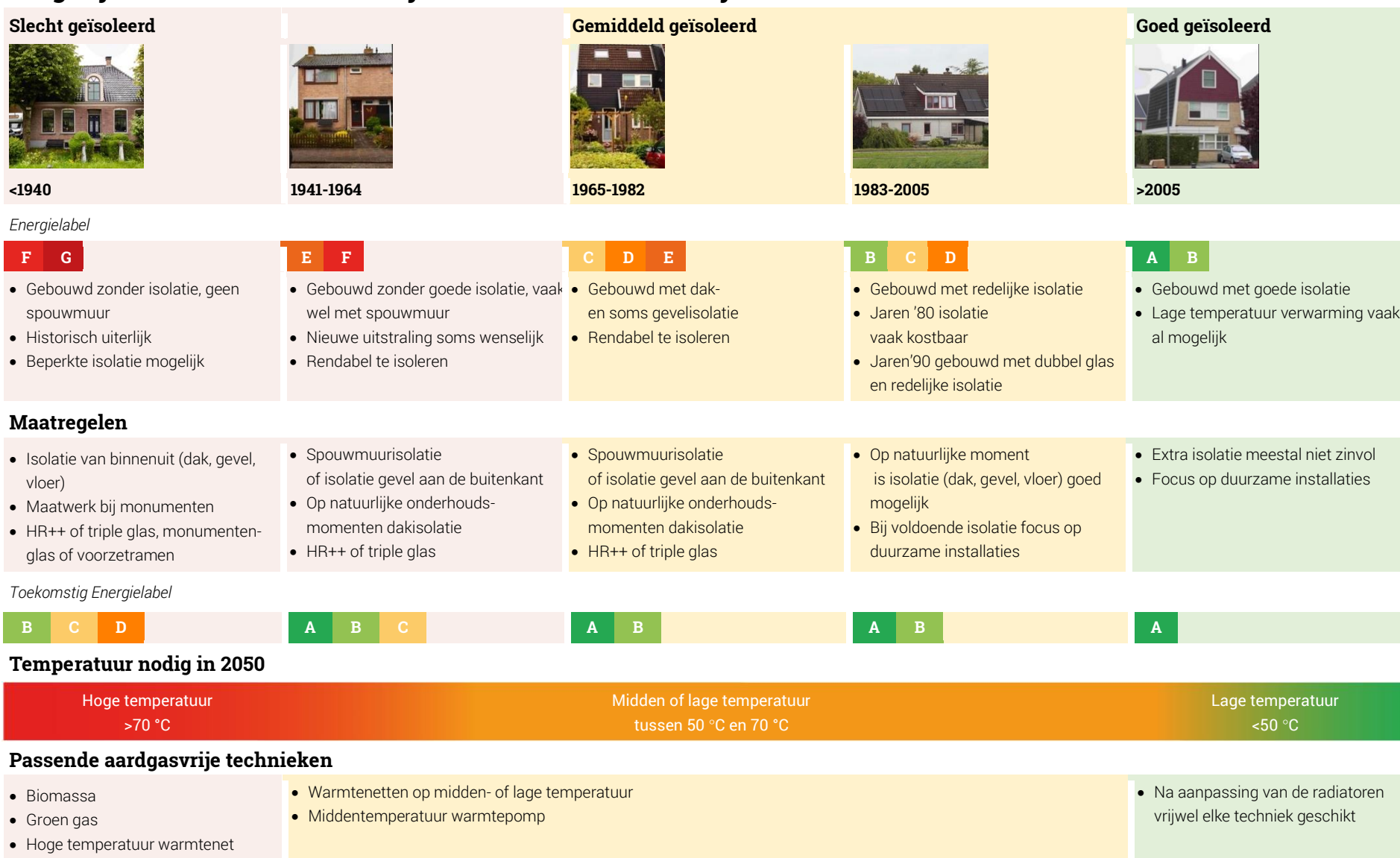
Figuur 7 Woningen uit verschillende bouwjaren hebben verschillende mogelijkheden voor isolatie.
